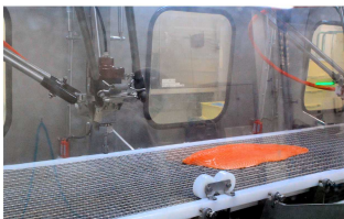
稼働中のウォーターカッター
